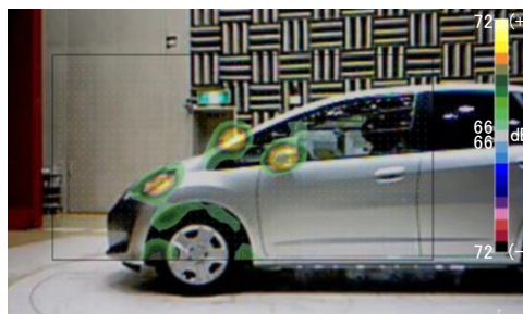
図 ビームフォーミング法を用いた、実車車外騒音分布の計測結果
