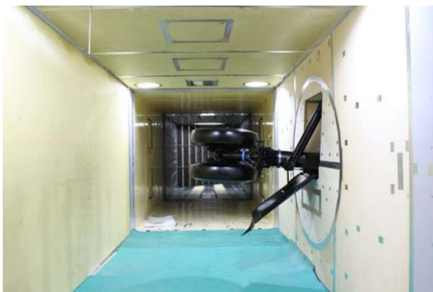
図1 飛翔主脚実大風洞試験模型 設置の様子
